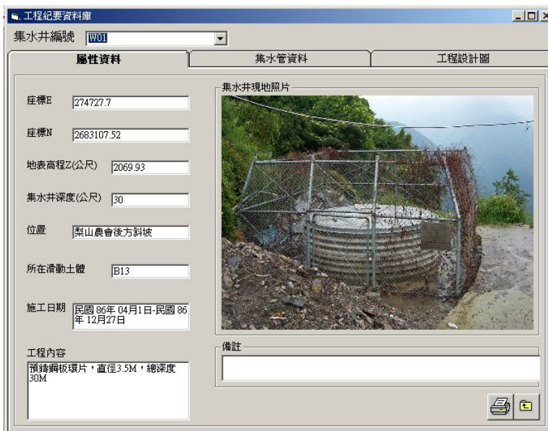
圖67 進入集水井資料庫選單中的查詢部分，查詢集水井的基本資料分為基本資料、集水管資料與工程圖庫之交換式選單
