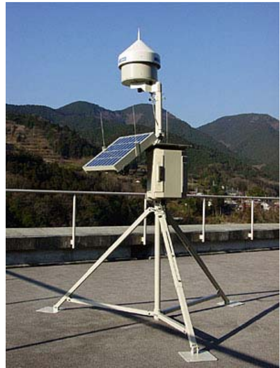
圖 39 現地固定式的 GPS 觀測設施
