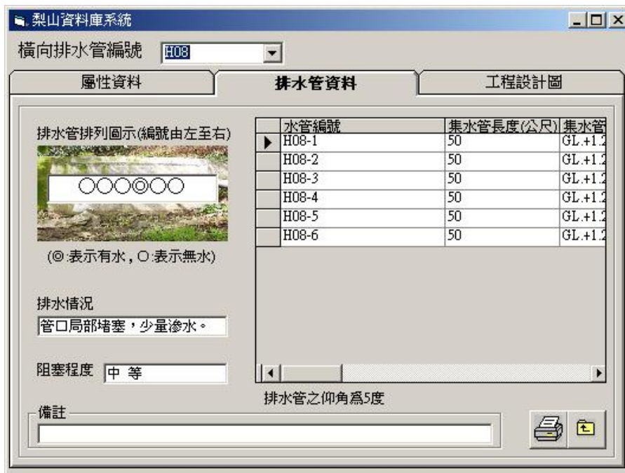
圖72 查詢橫向排水管調查的記錄，包括各排水管之屬性資料，以及經由現地探勘後之評估情形
