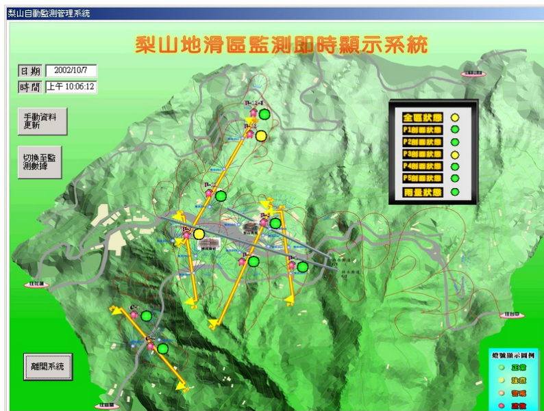
圖54 梨山地滑區即時監測系統畫面顯示
