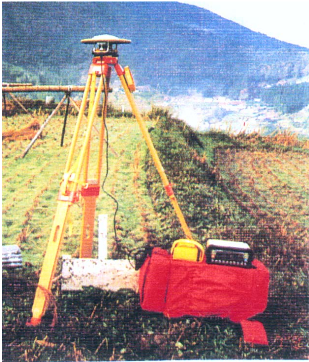
圖 38 可移動式的 GPS 觀測點設施
