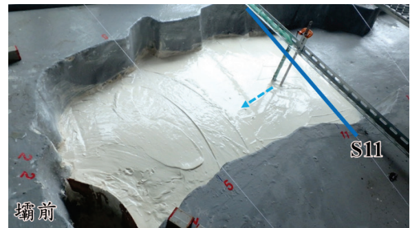
圖 13 Q_{10} 阻塞試驗布置示意圖
