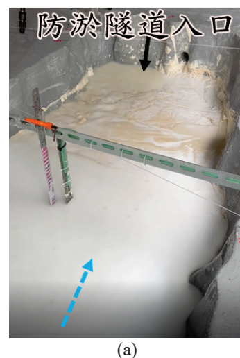
圖 13 Q_{10} 阻塞試驗布置示意圖
